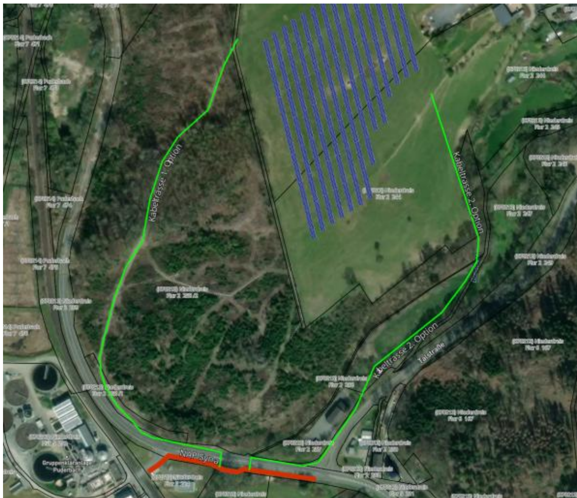
Abb. 16: Lageplan des möglichen Verlaufes der Kabeltrasse
