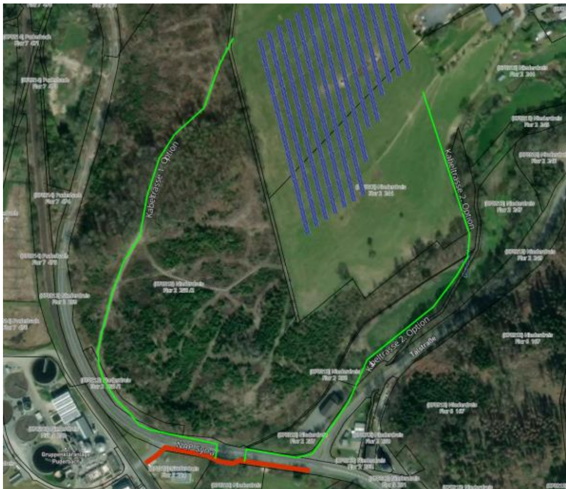
Abb. 11: Lageplan des möglichen Verlaufes der Kabeltrasse
