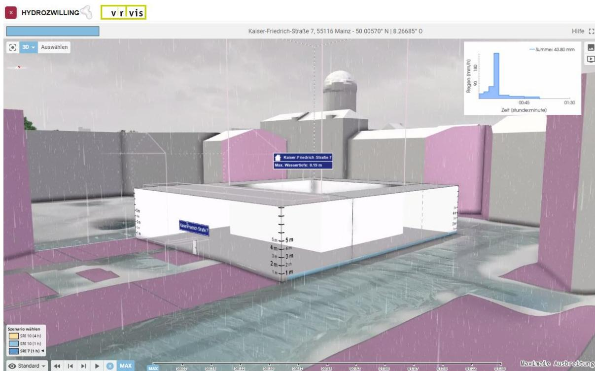
In der Seitenansicht ist die Gebäudefassade mit den Anschlaglinien der möglichen Wasseroberfläche in Metern des ausgewählten Starkregenszenarios angezeigt. Die maximale Wassertiefe dieses Gebäudes können Sie unter der Adresszeile dem eingebblendeten blauen Kasten entnehmen. Die animierten Wellen auf der Wasseroberfläche zeigen die Fließgeschwindigkeiten und -richtungen des ausgewählten Starkregenszenarios an.
